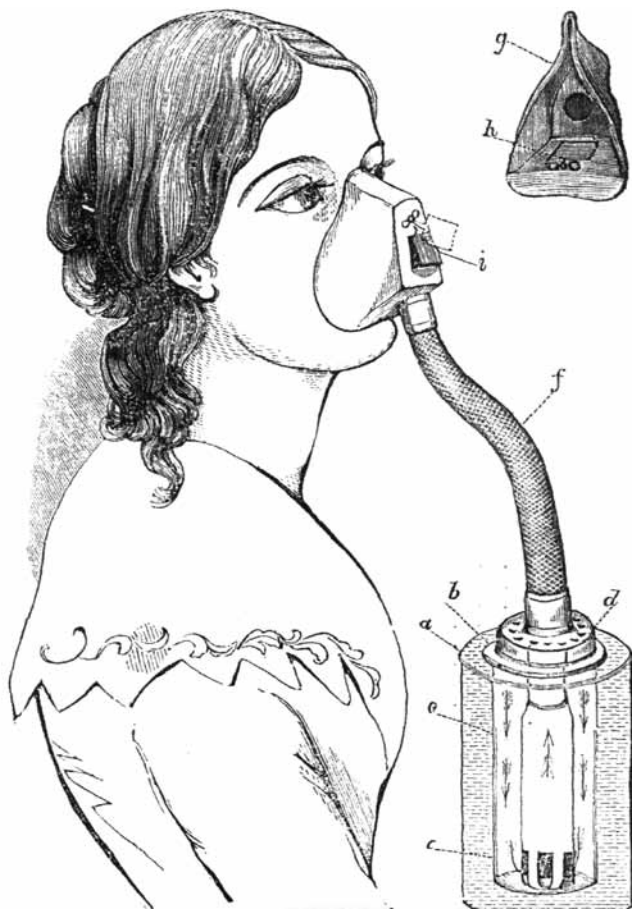
Snow's kloroforminhalator. Hvis vandkappetemperaturen blev holdt på 60°F, så afgav fordampere de nødvendige og sikre 14 vol% kloroform.
