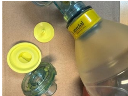
Bilde 2: Paraplyventil fjernet fra leppeventil. Resten av bagen var korrekt montert.
