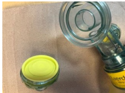
Bilde 1: Bildet viser en feilmontert Lærdalsbag. Paraplyventilen total-obstruerer åpningen i leppeventilen. I det gitte tilfellet mistenker vi at en ekstra paraplyventil var sammenklebet til leppeventilen ved montering etter vask.
